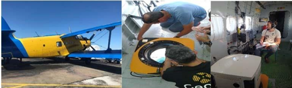
Figura 10. Modelo de aeronave AN-02 con matrícula CUC-1818 donde se acoplo la tecnología UltraCam –Lp en 2017.
