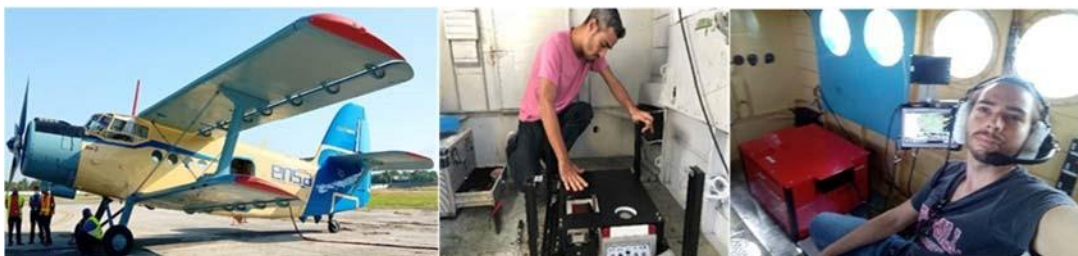
Figura 12. Modelo de aeronave AN-02 con matrícula CUC-1890 donde se acopló la tecnología LiDAR VQ-780i en 2022.
