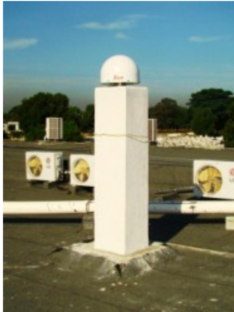
Figura 1. Estación de rastreo continuo HAVA
