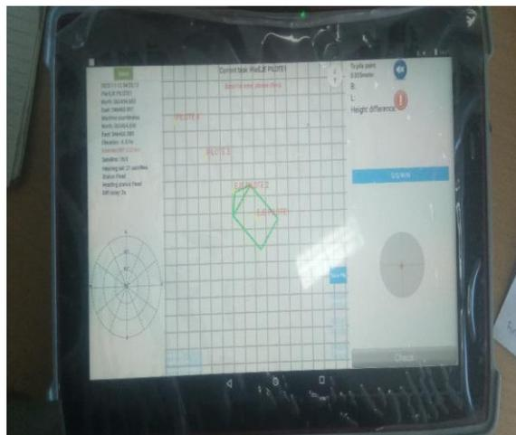
Figura 5. Inicio del replanteo de la hincada de pilotes.
