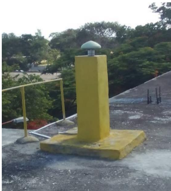
Figura 1. Estación GNSS de Rastreo continuo HOLG Concepción de la Campaña.
